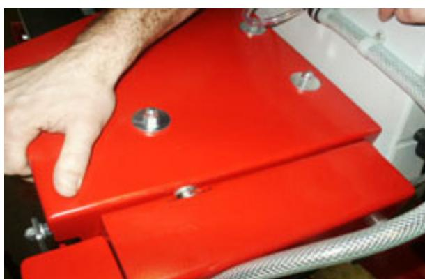
6. Поставете центриращия щифт в корпуса. Дръжте главата хоризонтално и завийте шайбата и гайката с 30 mm гаечен ключ (UK гаечен ключ)
